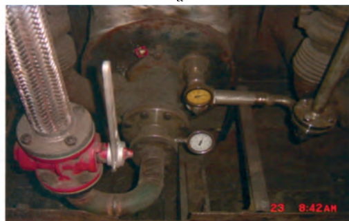
Рис.10. Установка кислородной трубки в горелке типа «Bloom» без нарушения брони и кладки: а — схема монтажа трубки подачи кислорода; б — действующая горелка с подачей кислорода; I — газ; II — воздух; III — кислород; 1 — трубопровод подачи кислорода.
