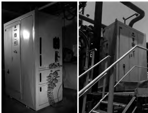
Рис.1. Плазменный модуль установки для переработки галогенсодержащих отходов компании E.S.T. Ltd.
