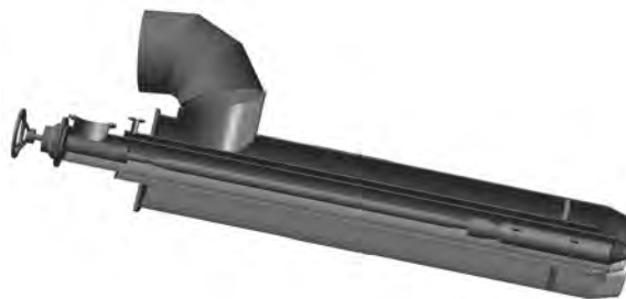
Рис.3. Горелка ПГ-35М с регулируемой длиной факела в разрезе.
