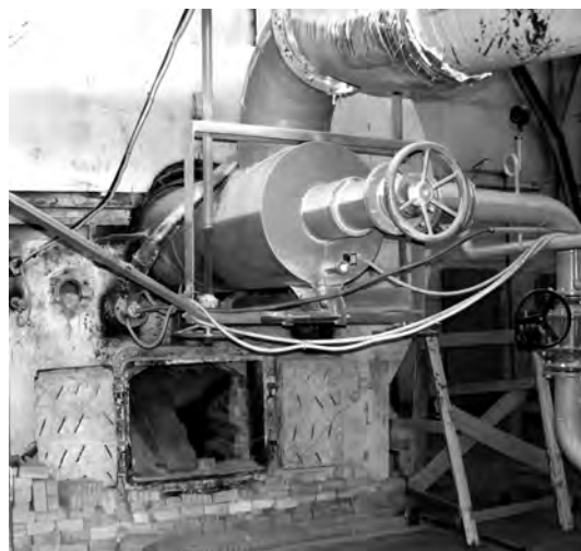
Рис.2. Установка горелки с регулируемой длиной факела в торце откатной головки печи.
