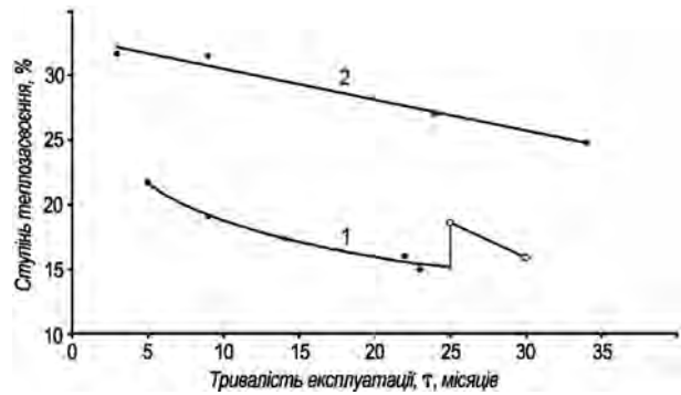
Рис.2. Динаміка зменшення ступеня утилізації тепла димових газів у залежності від терміну експлуатації рекуператора: 1 – піч № 1 ВАТ «Комбінат будіндустрії»; 2 – піч № 3 ДПП «Береабудматеріали».
