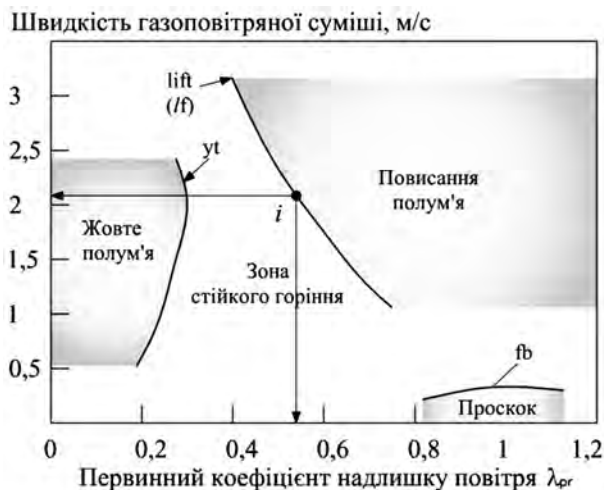
Рис.3. Взаємне розташування зони стійкого горіння та меж її порушення внаслідок повисання факелів, виникнення проскоку полум'я, появи жовтих язиків (неповне згоряння) при спалюванні природного газу з використанням пальника, характеристики якого дані на рис.2; «i» — контрольна точка.
