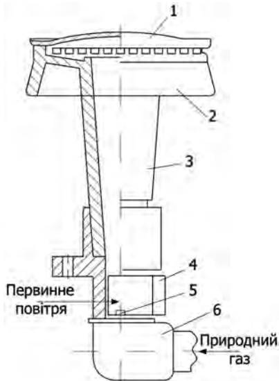
Рис.5. Вертикальний пальник [34]: 1 — кришка; 2 — вогневий насадок; 3 — дифузор; 4 — вікно для ежекції первинного повітря; 5 — сопло; 6 — корпус сопла.
