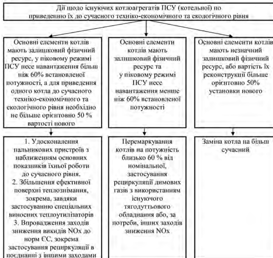
Рис.6. Схема-план дій щодо виконання екологічних директив ЄС котлоагрегатами паливоспалюючих установок одночасно з підвищенням їх техніко-економічних показників та ресурсу.
