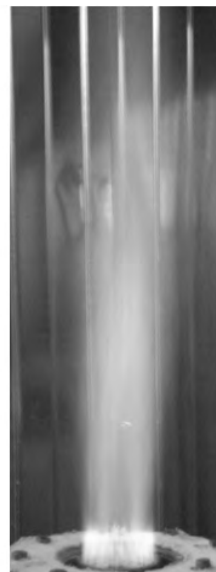
Рис.7. Факел при \lambda = 0,7 и содержании кислорода в смеси [\text{O}_2] = 18,28 %.
