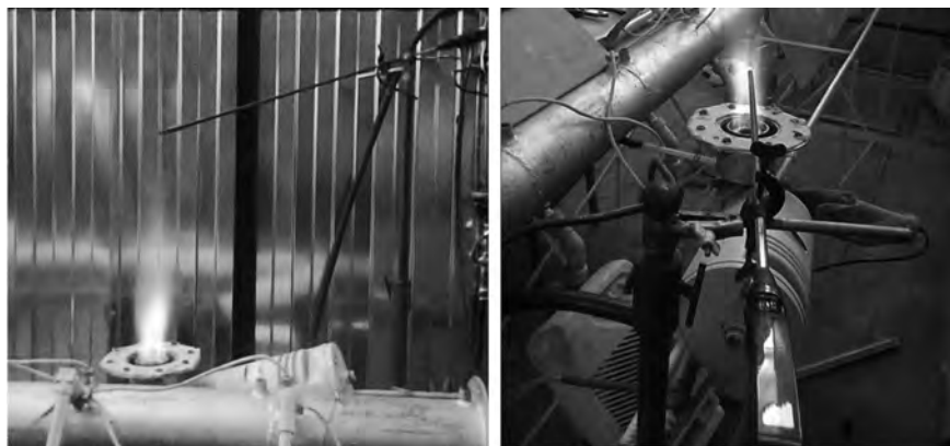
Рис.6. Установка пробоотборного устройства и зондирование открытого факела.
