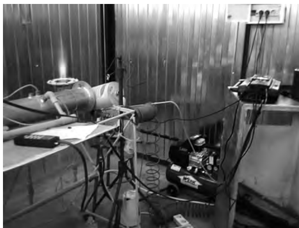
Рис.4. Внешний вид экспериментальной установки исследования влияния влаги на процесс сжигания природного газа в открытом факеле.
