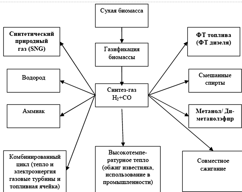
Схема использования синтез-газа, получаемого при газификации биомассы.
