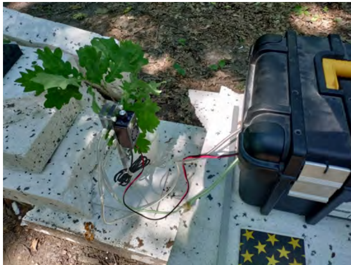
Рис. 3. Загальний вигляд польового газометричного апаратного комплексу та листової камери для вимірювання листового \text{CO}_2 -газообміну
