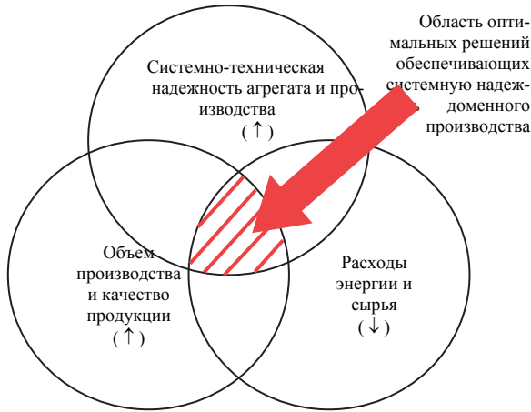
Рис.1. Архитектура системной надежности доменного производства и принятия компромиссных решений по ее обеспечению
