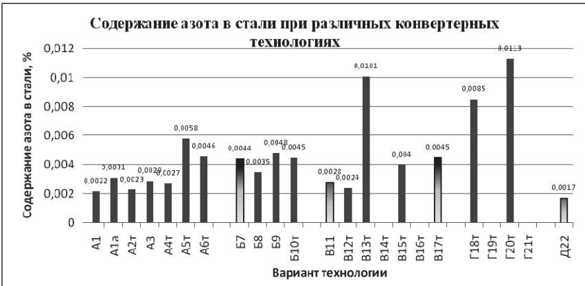
Рис.9. Содержание азота в стали при различных технологиях кислородно-конвертерной плавки. Обозначения те же, что и на рис.8.
