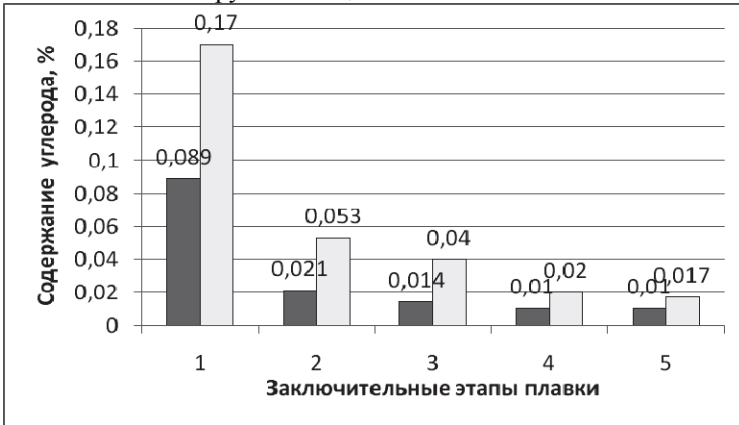
Рис.11 Изменение содержания углерода в металле по заключительным этапам плавки. Обозначения как и на рис.10.
