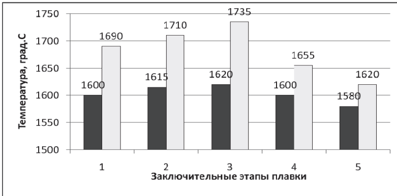
Рис.10. Изменение температуры металла по заключительным этапам кислородно-конвертерной плавки. На представленных рисунках левый столбик обозначает минимальное значение из совокупности данных, правый столбик – максимальное значение.
