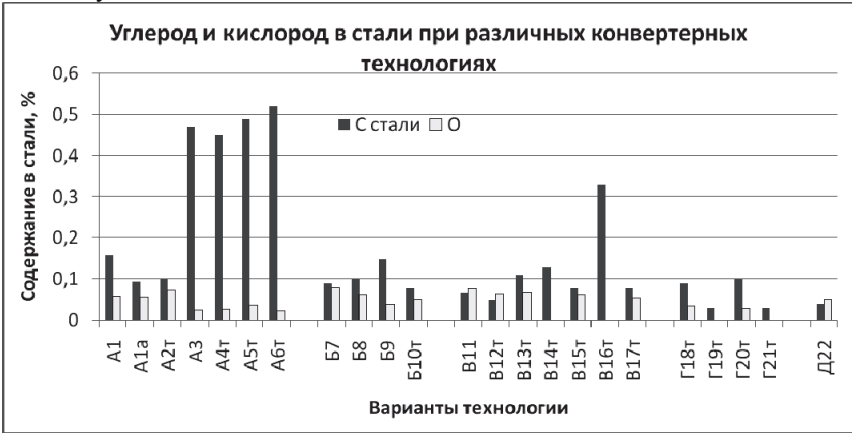
Рис.8. Содержание углерода и кислорода в металле при различных технологиях кислородно-конвертерной плавки (углерод – левые столбики, кислород – правые столбики). А,Б,В,Г,Д – базовые технологии, цифры – подварианты базовых технологий. Индекс «Т» обозначает применение топлива (теплоносителей: природный газ, угольное топливо в кусковом и порошкообразном виде).
