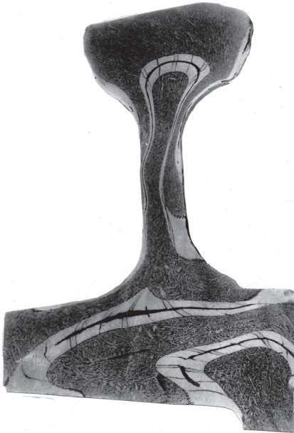
Рис.3. Темплет тепловозного центра после формовки на прессе мощностью 100000 КН
