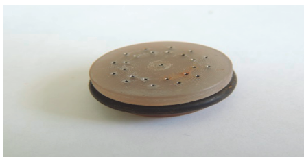
Рис.4. Внешний вид фурмы с уплотнительной резиной
