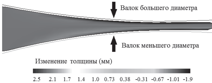
Рис. 8. Изменение толщины полосы при прокатке порошка титана
