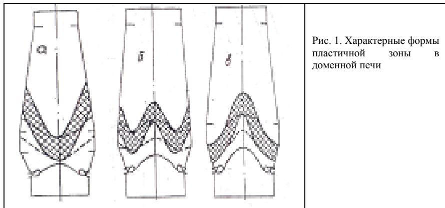
Рис. 1. Характерные формы пластичной зоны в доменной печи
