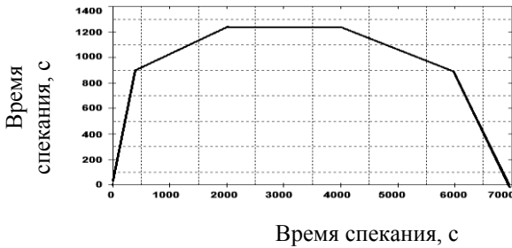
Рисунок 13 – Режим спекания прокатанной титановой пластины
