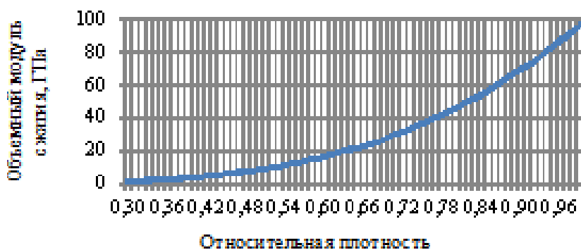
Рисунок 4 – Объемный модуль сжатия порошка титана в зависимости от разной относительной плотности [4]
