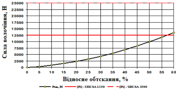
Рисунок 3 – Зміна тягового зусилля при деформації вихідної круглої заготівки діаметром 3,67 мм зі Ст.70
