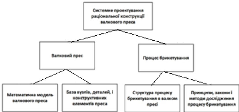
Рисунок 2 – Основні складові системного проектування валкового преса.
