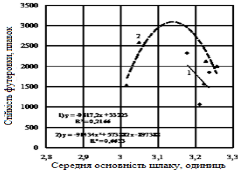
Рисунок 10 - Вплив рівня основності шлаку на стійкість футерівки 60-т конвертерів відповідно № 1 - 1, № 2 - 2.
