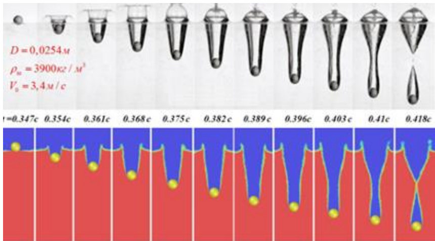
Рисунок 1 – Вхід сталеві кульки у воду [3].
