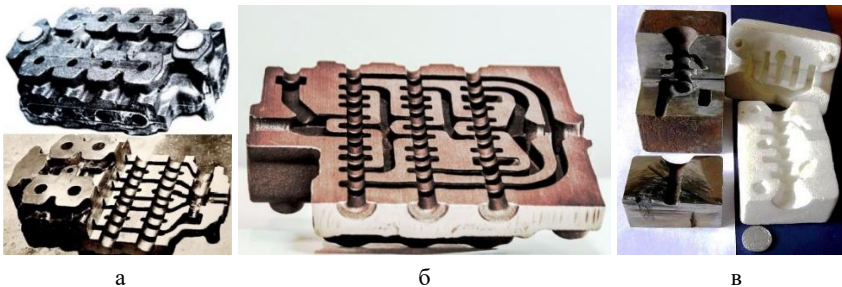
Рисунок 2 – Чавунні моноблочні гідророзподільники: а – виливок чотирисекційного розподільника і його деталь (нижче) з вирізом для показу каналів; б – деталь трисекційного розподільника розрізана навпіл для демонстрації каналів; в – виливок односекційного розподільника з вирізом і його пінополістирольна ливарна модель з двох половин.
