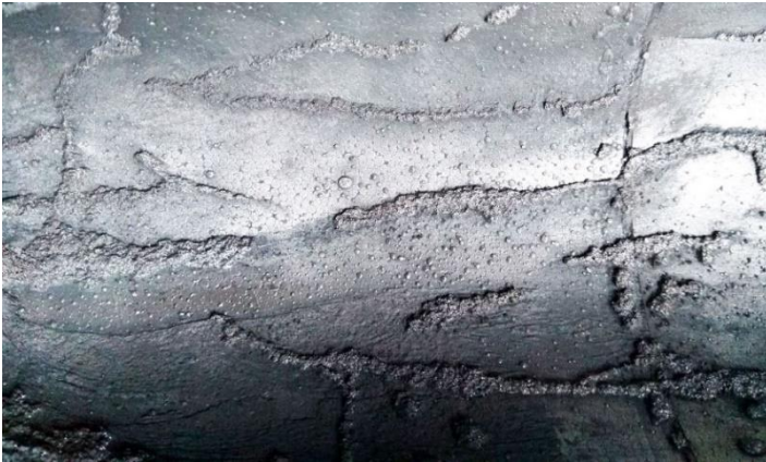
Рисунок 3 – Просічення на внутрішній поверхні чавунного вилівка при ЛГМ.
