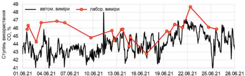
Рисунок 6 – Ступінь використання СО з автоматизованих та лабораторних вимірювань хімічного складу колошникового газу на одній з доменних печей ПрАТ «МК «Азовсталь».
