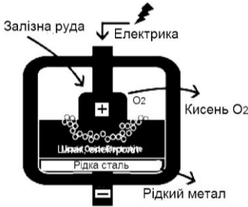
Рисунок 7 – Принципова схема електролізу розплавленого оксиду [17].
