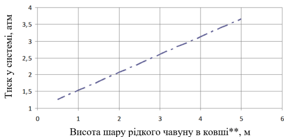
Рисунок 2 – Оцінка впливу глибини занурення фурми на надлишковий тиск, що діє на зону протікання хімічної реакції
