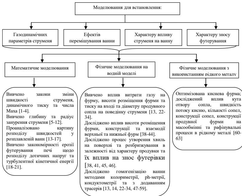
Рисунок 1 – Схематичне представлення можливостей існуючих методів моделювання киснево-конвертерного процесу
