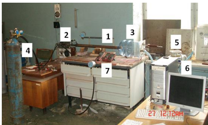
Рисунок 2 – Фото стенду дослідження високовольтної активізації газового струменя: 1 - фурма; 2 - високовольтне джерело струму; 3 - прозора ємність; 4 - балон з киснем, обладнаний редуктором; 5 - прилад Циклон-5-21 для виміру рівня озону, 6 - персональний комп'ютер для безперервної реєстрації показників, 7 - прилади для реєстрації показників продувки
