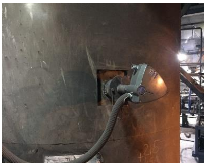
Рисунок 2 – Прилад Durag що застосовується у аглодоменному переділі
