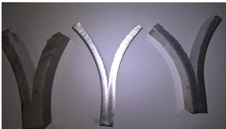
Рисунок 3 – Руйнування зразків шириною 30 мм зі сплаву системи Al-Mg-Sc при прокатці
