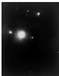
Рисунок 4 – Тонка структура залишкового аустеніту; \times 30000
