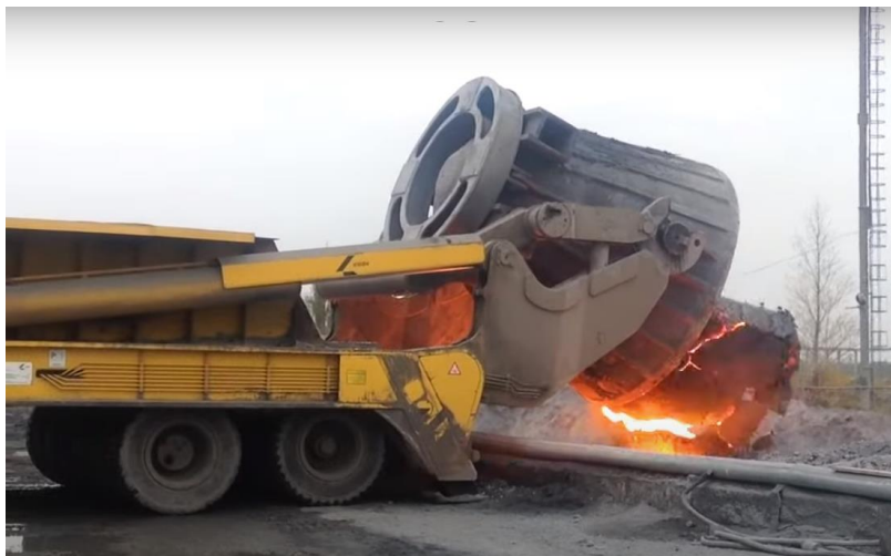
Рисунок 1 – Випадання гарнісажу зі шлакової чаші на автомобільному ході в процесі зливання шлаку
