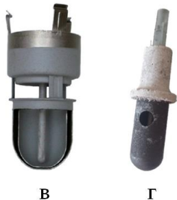
Рисунок 1 – Відомі пробовідбірники для відбору проб розплаву при застосуванні термічного аналізу: а, б – пробовідбірники наливного типу; в – пробовідбірник занурення із подвійною тонкою сталеву стінкою (посудина Дьюара); г – графітовий пробовідбірник занурення (розроблений Смульським А.А. [5])
