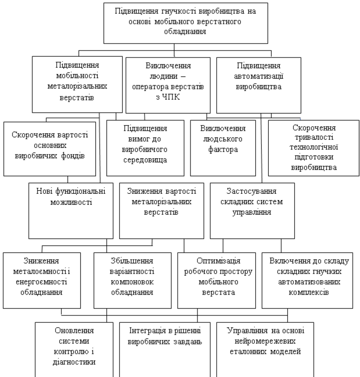
Рис. 1. Взаємозв'язок ознак виробництва на базі мобільних верстатів з кінематикою паралельної структури
