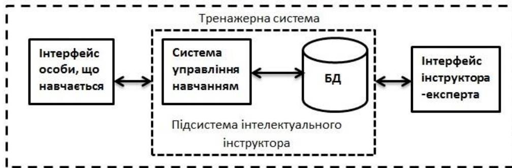
Рис. 2. Схема комп'ютерного тренажера з автоматизованою функцією інструктора
