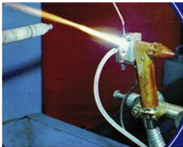
Рис.1. Плазмотрон для плазменного напыления
