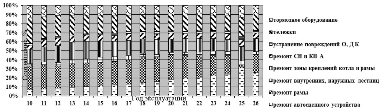
Рис. 3. Процентное соотношение выполненных ремонтов основных элементов цистерны (О - обечайка котла; ДК - днище котла; СН и КПА - сливноналивная и комплектующая арматура)
