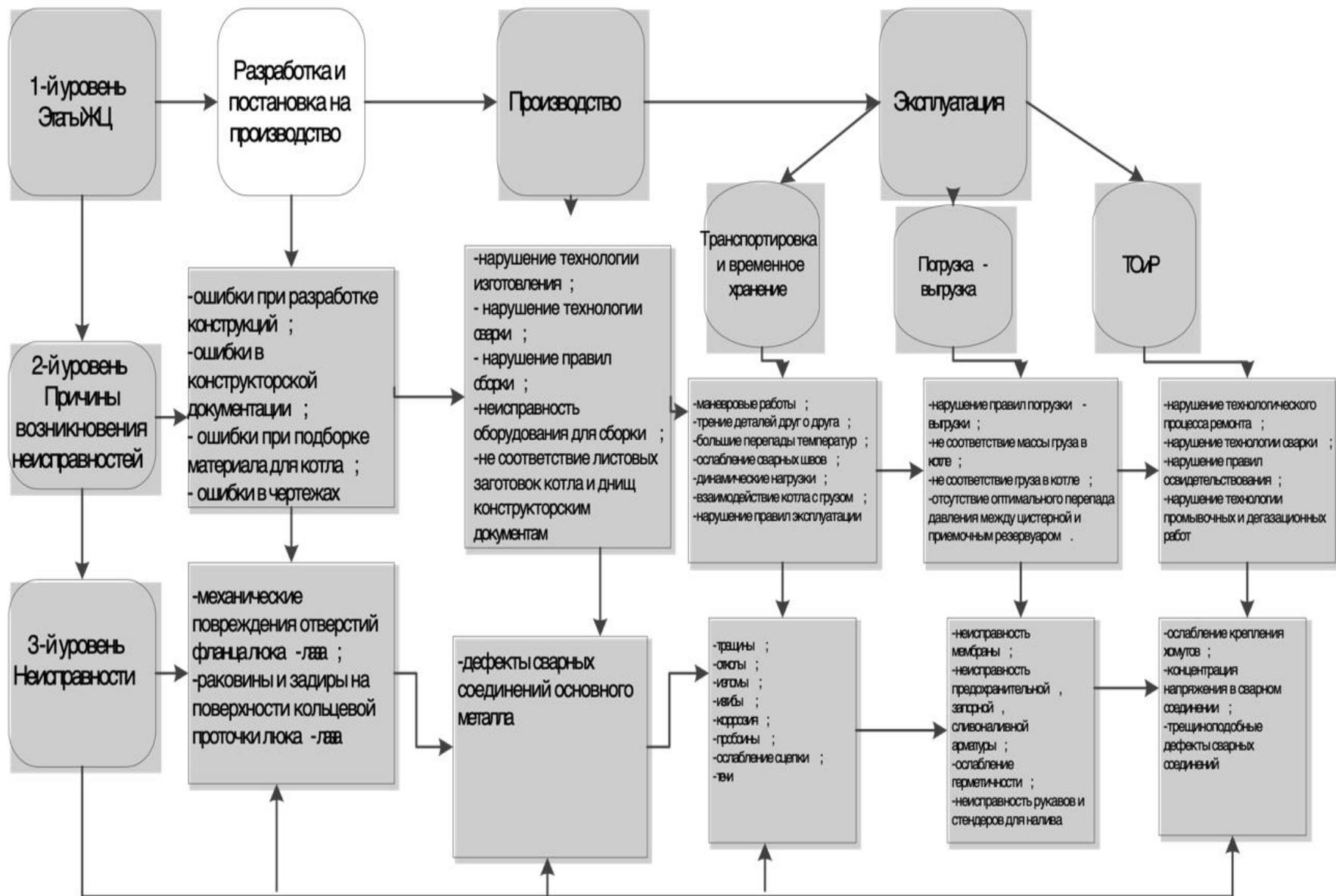
Рис. 4. Классификация повреждений цистерн на этапах ЖЦ
