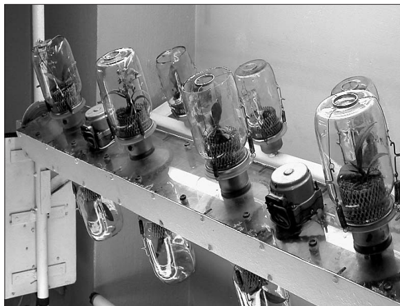
Загальний вигляд кліностата та дослідних видів орхідних ( Doritis pulcherrima Lindl.)
