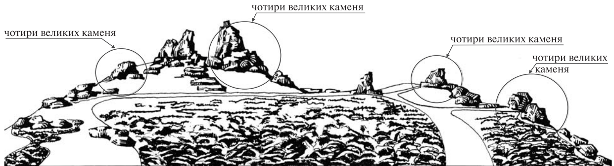
Рис. 1. Схема кам'яних угруповань, які нині перебувають в аварійному стані у гірській частині і потребують негайного цементування та засипки глиною на 1/3 їхньої висоти
