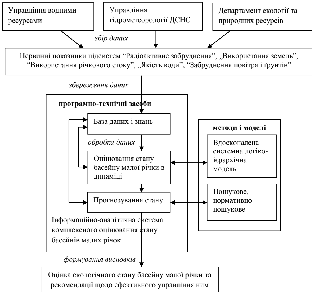
Рис. 1. Структурна схема інформаційної технології оцінювання динаміки та прогнозування екологічного стану басейнів малих річок
