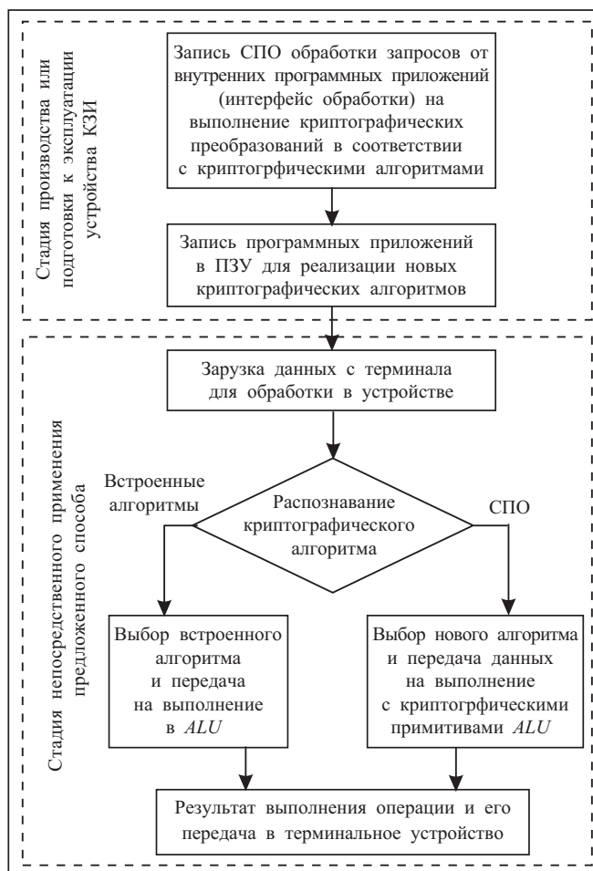
Рис. 1. Алгоритмическая схема применения способа использования различных криптографических алгоритмов в средствах КЗИ
