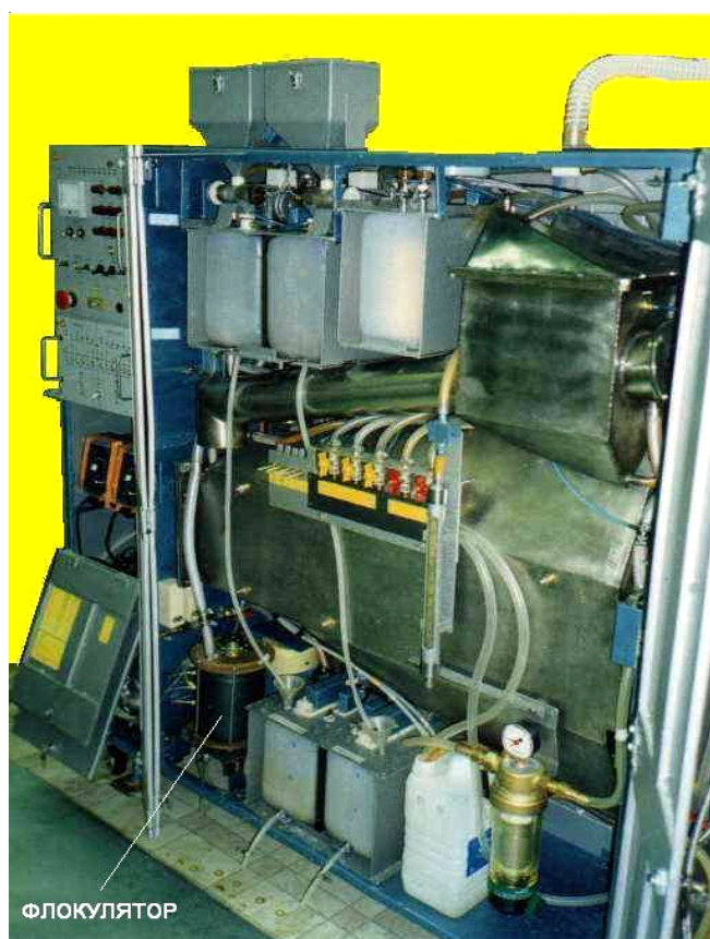
Рис. 11. Установка для флокулярно-микрофлотационной сепарации отработанных смазочно-охлаждающих водомасляных эмульсий
