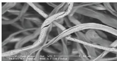
Рис. 3. РЭМ-изображение привитых волокон целлюлозы-g-CDNMA.
