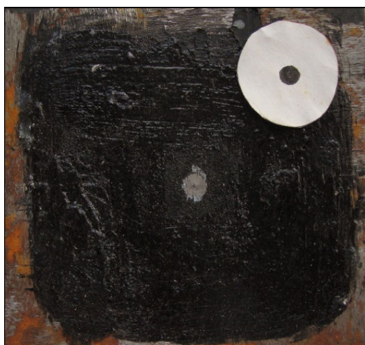
Рис. 4. Состояние образца после отслоения разработанного покрытия (выдержка 30 суток в 3 % NaCl в условиях катодной поляризации (-1,5 В). Для сравнения приведен круг с максимально допустимым радиусом отслаивания
