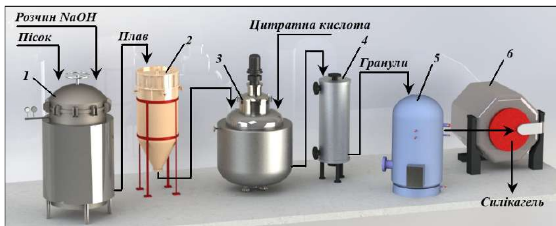
Рис. 8. Апаратурна схема одержання силікагелю: 1 – автоклав, 2 – фільтр, 3 – змішувач, 4 – башта с маслом, 5 – бак з нагрівом, 6 – прожарювальна піч
