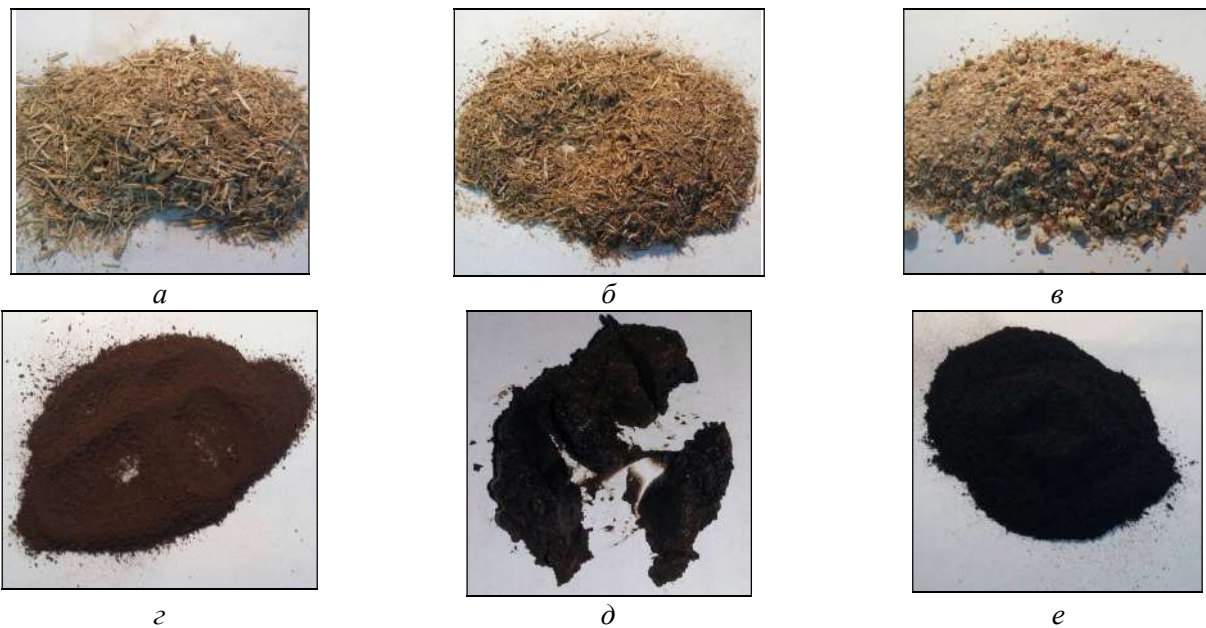
Рис. 1. Органовмісні відходи, як компоненти сумішевих палив: a – очерет (0,5–10 мм); б – щавель кінський (0,5–10 мм); в – кукурудзяні качани (0,2–10 мм); г – лігнін (0,02–1 мм); д – осад БСА, після зневоднення в геоконтейнері (0,02–1 мм); е – пил вугілля антрацит (0,02–1 мм)
