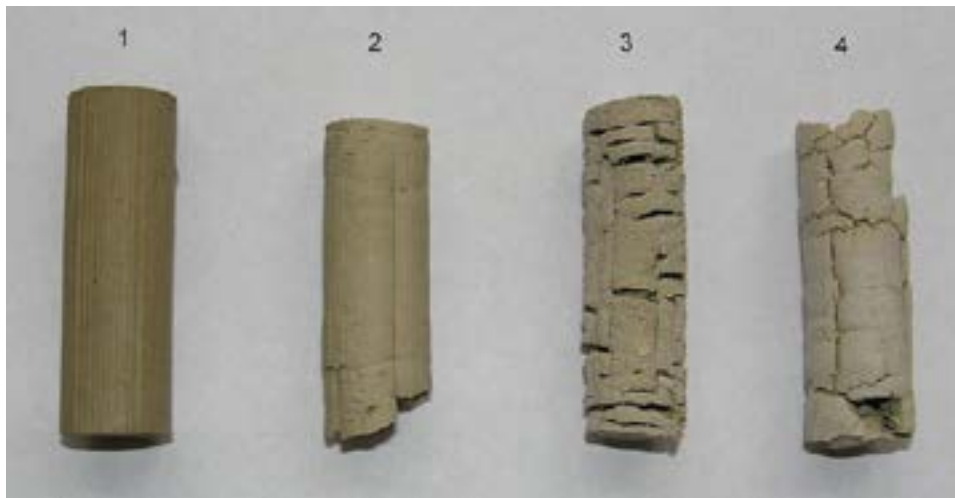
Рис. 5. Гранули природної глини (2) та її Na + -заміщеної форми (1, 3, 4) до (1) та після сушіння (2, 3, 4) при температурі 160°C і швидкості теплоносія 3,0 м/с. Вихідна вологість зразків: 2 – 32,79; 3 – 49,67 та 4 – 35,39%.
