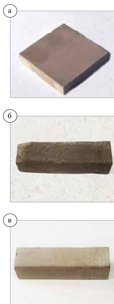
Рис. 2. Зовнішній вигляд зразків СП-10П, СП-10Ш та СП-10Т відповідно, отриманих за методом: а) пресування, б) шлікерного лиття, в) термопластичного формування
