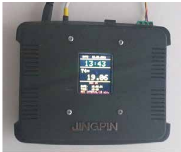
Рис. 3. Вторинні прилади для безперервного моніторингу значень температури на експериментальному стенді
