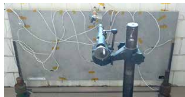
Рис. 1. Обігрівач електричний керамічний «Теплокамінь» із групою датчиків температури на поверхні та термоанемометром в штативі
