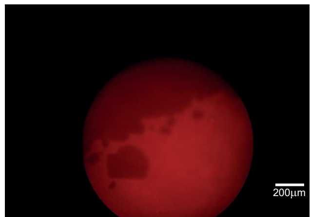
Рис. 3. Критичне фазове перетворення у зразку еритроконцентрату з кріоконсервантом ЦНДІГПК-11 5 під час охолодження.
