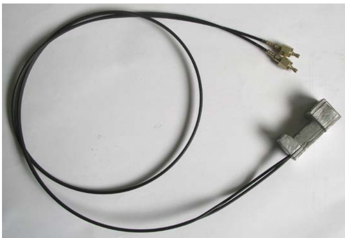
РИС. 6. Вигляд оптичної голівки з оптичним кабелем
