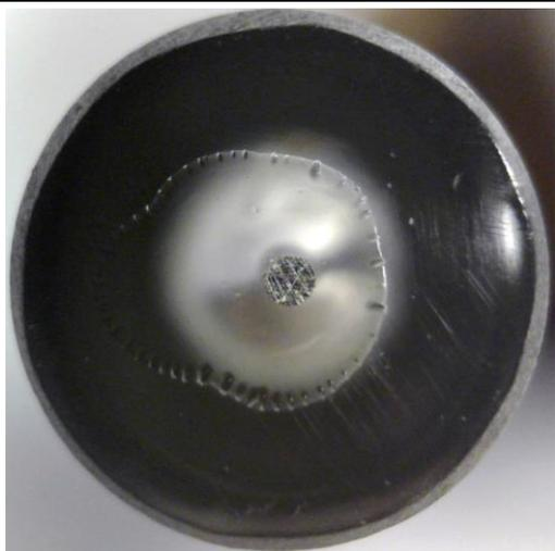
РИС. 2. Фермент, нанесенный на поверхность мембраны биосенсора
