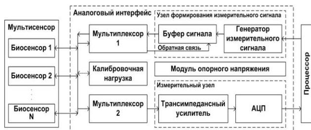
РИС. 3. Блок-схема аналогового интерфейса сенсорной сети
